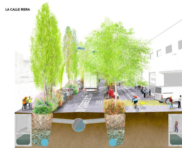
Figura 59. Recolección de agua pluvial .Imagen recuperada de https://www.archdaily.mx/mx/771701/la-nueva-fabrica-urbana-el-eco-parque-industrial-de-torrent-estadella-barcelona
